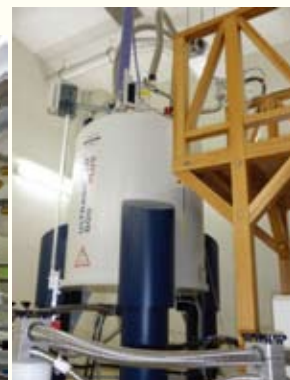
800MHZ-NMR 装置 (Bruker AVANCEIII 800 Cryo probe 付き)
