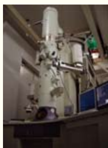
エネルギーフィルタ内蔵透過型電子顕微鏡 (300kV TEM)
