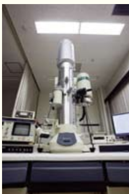
高分解能透過型電子顕微鏡 HR-TEM (日立 H-9000NAR)
