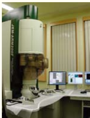
原子分解能走査透過型電子顕微鏡 STEM (日本電子 JEM-ARM200F)
