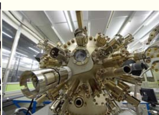
クリーンルーム内の半導体結晶成長装置 (Riber MBE32P, Semiconductor crystal growth system)
