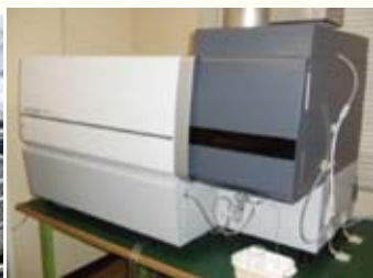
ICP 発光分光分析装置 (島津 ICPE-9000)
