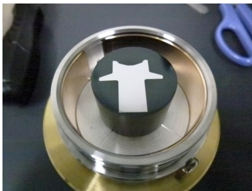
図1 樹脂埋め込みされたボルト断面
