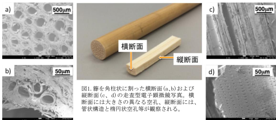
図1. 籐を角柱状に割った横断面(a, b)および縦断面(c, d)の走査型電子顕微鏡写真。横断面には大きさの異なる空孔、縦断面には、管状構造と楕円状空孔等が観察される。
