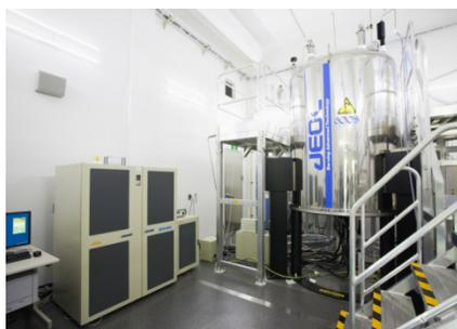
図1. 800 MHz強磁場核磁気共鳴装置.
